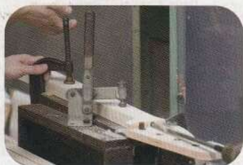
◎ トラスロッドの埋め込みも手作業だ。
