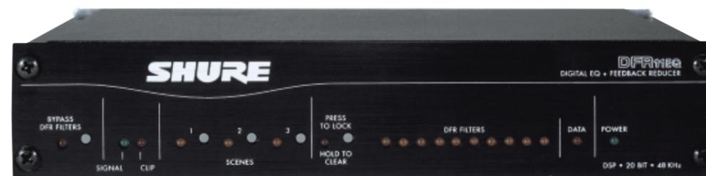
1入力、1出力構成。入力された信号は「フィードバック・リデューサ」「イコライザ」「リミッタ」「ディレイ」の順で処理。
