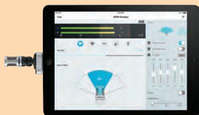
Lightningコネクタを搭載したiPhoneやiPadに無料のiOSアプリ「ShurePlus™ MOTIV」をインストールすることで、全MOTIVシリーズの24bit/48kHz、wav形式によるレコーディングをソフトウェア上で実行可能。音声、メーターによるモニタリングやゲインの調整を行えます。
