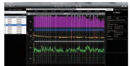
リハーサル時や本番時にWireless Workbench® 6を起動しておけば、運用中の送信機の電波状況をリアルタイムでモニタリング可能。時間軸で状況を把握できるため、外来電波の判別やドロップポイントの特定を高い精度で実行できます。
