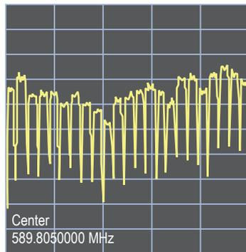
実際のスペクトラムスキャン結果。従来16チャンネルの運用であった周波数帯域で47チャンネルを運用できていることがわかります。(米国の周波数運用例)
