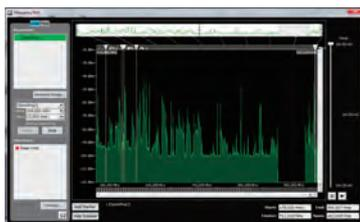
ソフトウェア上で使用する機材や運用する周波数帯域、同時利用チャンネル数を設定すれば、TVチャンネルや現場の電波状況を入力し、最適な周波数チャンネルを選出。決定したチャンネルは赤外線経由でボタン1つ押すだけで送信機へ転送できます。
