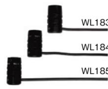
【仕様】 ●指向特性:WL183 無指向性、WL184 スーパーカーディオイド、WL185 カーディオイド ●周波数特性:50Hz~17kHz ●最大音圧レベル:WL183 125dB SPL、WL184 129.5dB SPL、WL185 130.5dB SPL ●コネクター:Switchcraft TA4F ●寸法:φ12×長22mm(マイク部のみ) ●ケーブル長:1.2m
