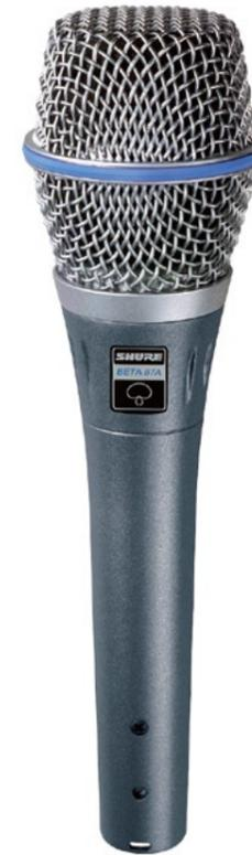
【BETA 87C仕様】 ●指向特性:カーディオイド ●周波数特性:50Hz~20kHz ●インピーダンス:150Ω ●開回路感度:-51dB re 1V/Pa ●等価雑音レベル:22dB SPL (Aウェイト) ●最大音圧レベル:139dB SPL (1kHz, THD0.25%) ●電源:ファンタム DC11~52V/1.0~1.2mA ●コネクター:XLR3ピン、オス ●寸法・質量:φ51×全長192mm、200g ●付属品:マイクホルダー(A25D)、3/8"→5/8"変換ねじ、マイクポーチ ●別売ウインドスクリーン(A85WS)
