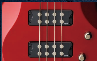
ピックアップ (TRBX300シリーズ) ラージポールピースとセラミックマグネットを採用した高出力設計。ハムキャンセル機能の採用で、パワフルなサウンドながらノイズが少ない仕様。フィンガーレス付きピックアップカバーで演奏性も抜群。
